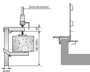
Klemmbare Geländerpfostenhalterung für senkrechte und waagerechte Bauteilräder.
