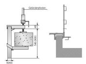
Klemmbare Geländerpfostenhalterung für senkrechte und waagerechte Bauteilränder.
