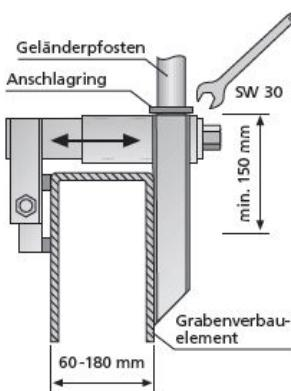
Klemmbare Geländerpfostenhalterung zum Einsatz an Grabenverbau-Elementen. Geeignet für Element- bzw. Wandstärken zwischen 60 und 180 mm.
