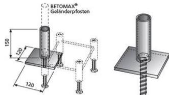
Zusatzbauteil für Spl 1 / Spl 2-Anker.
