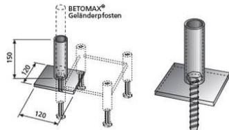
Zusatzbauteil für Spl 1 / Spl 2-Anker.
