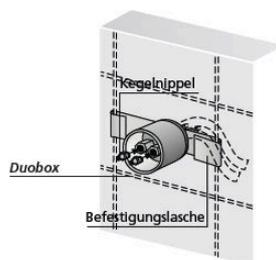
Der Dichtheit von Betonbauwerken wird eine immer größere Bedeutung zugemessen. Arbeitsfugen in Bauteilen sind konstruktiv und arbeitstechnisch unvermeidbar. Nicht aber die in diesen Bereichen immer wieder auftretenden Feuchtigkeitsschäden. Notwendige Sanierungen sind aufwendig und verursachen hohe Kosten. Das stark wachsende Bewusstsein für Qualität und Dauerhaftigkeit fordert neue, konstruktive Lösungen, die eine langfristige Dichtungsreserve garantieren.
