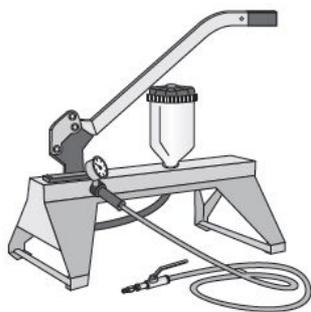
Verpressgerät zum Injizieren mittels Bohrpäckern.
