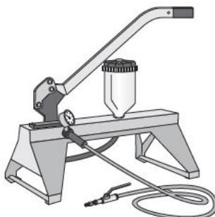
Verpressgerät zum Injizieren von Zement
