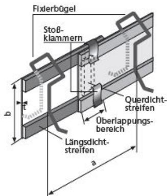
Aufstellen des Fugenbleches (SDF Q1 oder Q2) auf der oberen Bewehrung.
