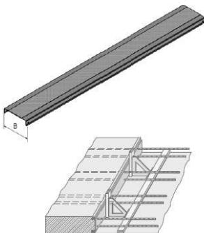
Hervorragende Verbundwirkung der Bleche durch Profilierung und Perforierung
