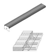
Hervorragende Verbundwirkung der Bleche durch Profilierung und Perforierung
