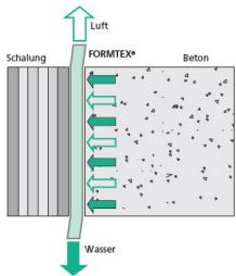
Die FORMTEX®-SK-Schalungsbahn wird vorwiegend zur Optimierung der technischen Beton-Eigenschaften verwendet.
