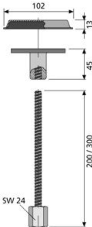
Mit dem KNACKER® lassen sich auch komplizierte oder besonders fest haftende Schalelemente leicht lösen. Der gehärtete Deckel ermöglicht den mehrfachen Einsatz des KNACKER®s.
