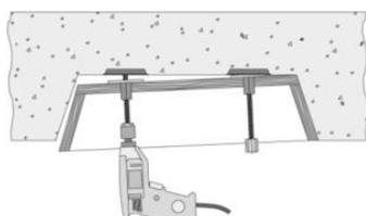
Mit dem KNACKER® lassen sich auch komplizierte oder besonders fest haftende Schalelemente leicht lösen. Der gehärtete Deckel ermöglicht den mehrfachen Einsatz des KNACKER®s.
