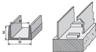
Distanzprofil mit Nagellöchern zum Ausrichten und Ansetzen von Wandschalelementen. Statt Holzlatten, die aufquellen und später verrotten. Um Wasserumläufigkeit zu vermeiden, Basisleiste nicht über die ganze Breite, sondern versetzt anordnen.
