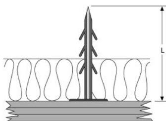
BETOMAX® Dämmplattenhalter aus Kunststoff.
