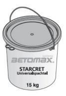
Gebrauchsfertige Trockenmischung auf Zementbasis, kunststoffvergütet. Für Ausbesserungen, Beschichtungen und zum Glätten, Nivellieren von Beton, Putz und Mörtel. Speziell für Sichtbetonkosmetik für innen und außen. Körnung 0 - 0,3 mm
