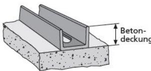
ISO-TRICK für den Einsatz auf weichem Untergrund, z.B. bei gedämmten Decken und Betonböden.
