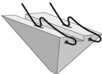
Einzel-Abstandhalter zur Betonrohrfertigung für Stabstahl Ø 6 - 10 mm.
