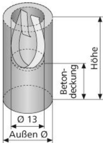
Einzel-Abstandhalter zur Betonrohrfertigung. Für Stabstahl  $\varnothing$  6 - 10 mm.
