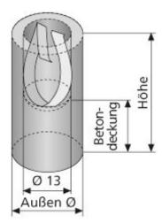
Einzel-Abstandhalter zur Betonrohrfertigung. Für Stabstahl  $\varnothing$  6 - 10 mm. Laut Merkblatt DBV-c-L2.
