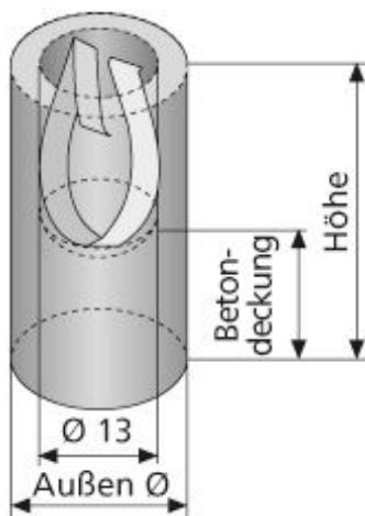
Einzel-Abstandhalter zur Betonrohrfertigung. Für Stabstahl Ø 6 - 10 mm.
