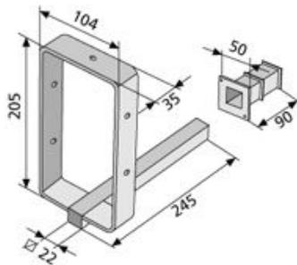
Verankerung zum Einsetzen von Kanthölzern (max. 10 x 20 cm). Einsatz in Stahlbetondecken/-wänden/-aussparungen z. B. im Bereich von Aufzugschächten. Zulässige Belastung: max. 15 kN
