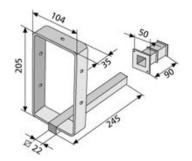
Verankerung zum Einsetzen von Kanthölzern (max. 10 x 20 cm). Einsatz in Stahlbetondecken/ -wänden/ -aussparungen z. B. im Bereich von Aufzugschächten. Zulässige Belastung: max. 15 kN
