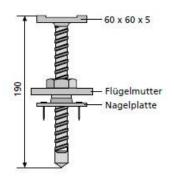
Spindelaufsatz für Kanthölzer ab 8 x 8 cm. Einsatz als Spannstütze, z. B. als Anschlag für Zwischenmauerungen.
