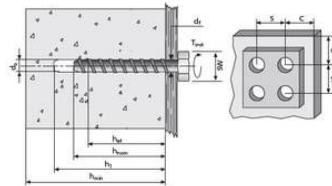
Zur Befestigung von Richstützen und BETOMAX® Schrammbord-Schalungen, verzinkt.
