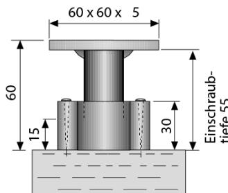
Befestigungsteil mit metrischem Gewinde, Verschluss mit Stopf 20.
