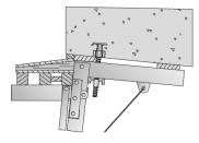
Befestigungsteil mit metrischem Gewinde, Verschluss mit Stopf 20.
