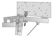
Befestigungsteil mit metrischem Gewinde, Verschluss mit Stopf 20.
